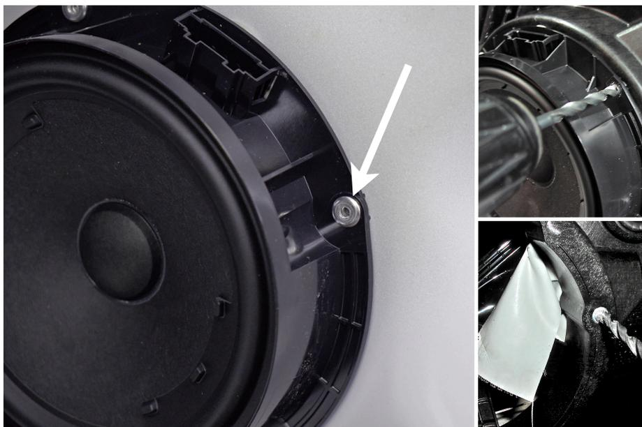
Tragen Sie auf den Lautsprecheradapter, zwischen Adapter und Aggregatenträger, ein Dichtungsmittel auf. Dieser wird dann mit beiliegenden M4 Schrauben am Aggregatenträger befestigt.
