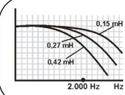
Falls der Mitteltonbereich zu laut ist, kann durch vergrößern des Spulenwertes der Pegel gesenkt werden.
