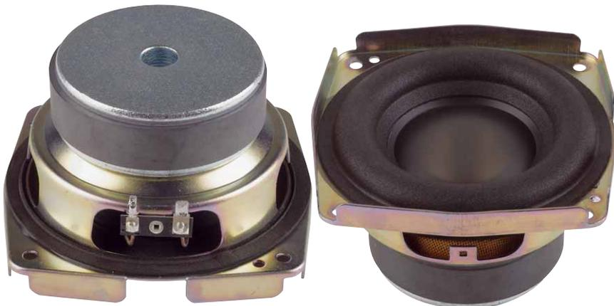
Klein, aber oho: Zwei der nur 13 Zentimeter messenden Woofer sind im MW500Q verbaut. Jeder arbeitet mit einer steifen Membran, einer breiten Schaumsicke und einer 38-mm-Schwingspule
