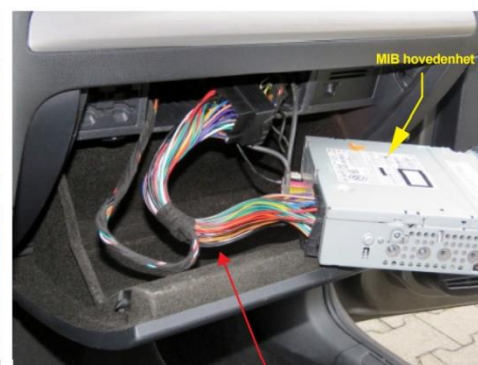
Koble til norDAB Quadlock T-kabelsett mellom MIB hovedenhet, MIB skjerm og norDAB modul
