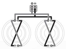
GX12D2 / GX10D2 / GX8D2 = 1/2 OHM GX12D4 / GX10D4 / GX8D4 = 1 OHM
