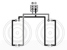
GX12D2 / GX10D2 / GX8D2 = 2 OHM GX12D4 / GX10D4 / GX8D4 = 4 OHM
