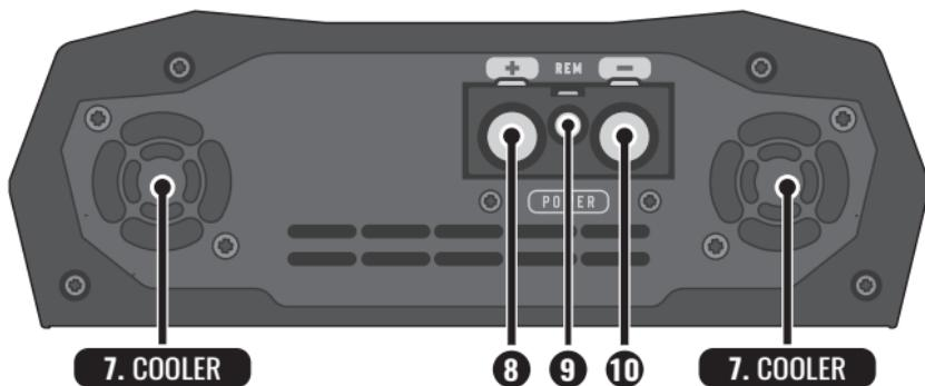
**7. COOLER:** Proporciona enfriamiento para el amplificador. Realice la instalación en un lugar ventilado, sin obstruir las entradas y salidas de aire.
